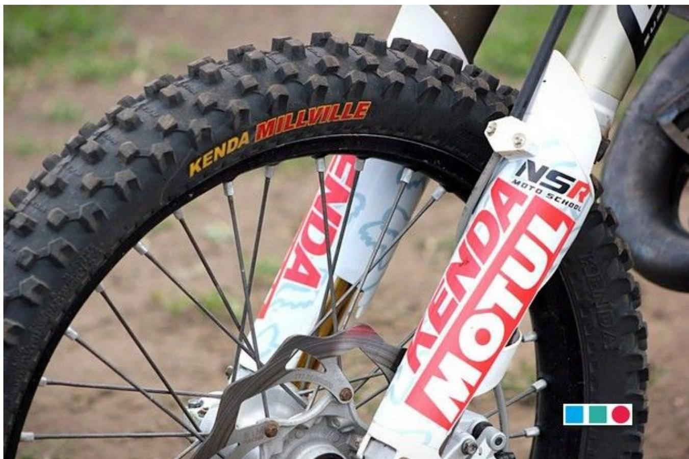
Сразу отмечу универсальность этой шины — она имеет направленный рисунок протектора в обе стороны: для мягкого и более твердого грунта. Если ставить K771 на мягкий грунт — шипы будут расположены в форме "лопатки", что позволяет отлично контролировать мотоцикл на мягких трассах. Если же развернуть покрышку в обратную сторону — шикарный зацеп на твердом грунте гарантирован.
